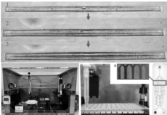
Рис. 1. а — деление иммобилизованной диатомеи (стадии 1–3) и примеры контрастных органелл (синие стрелки), осуществляющих \sim 1D -движение (зеленая стрелка), см. тайм-лапс видео; б — роботизированная станция, автоматизирующая подготовку и выполнение анализа; в — количественный ДОРМ с использованием линейки разбавлений в роботизированной станции и в лаборатории-на-чипе, на примере флуоресцина и метиленовой сини
